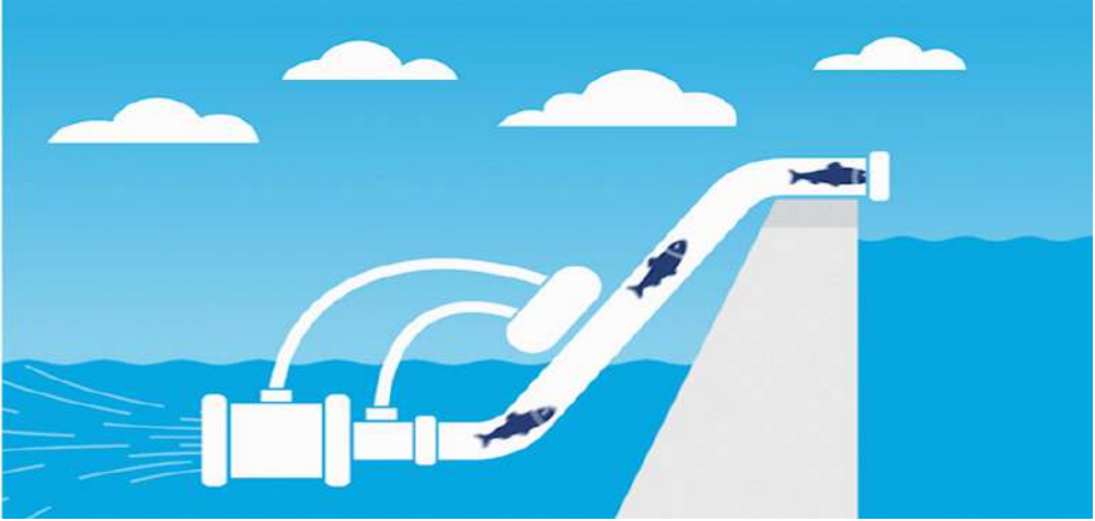
Şekil 23: Balık Geçiş Kanalı( https://www.energysage.com , 2019)
